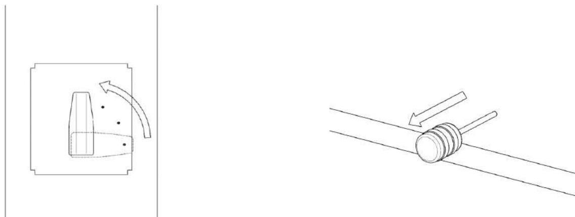
Отверстие для поступления воздуха управляется при помощи регулятора тяги воздуха, расположенного на панели под духовым шкафом. Чтобы открыть воздушную заслонку потяните ручку до упора на себя.
