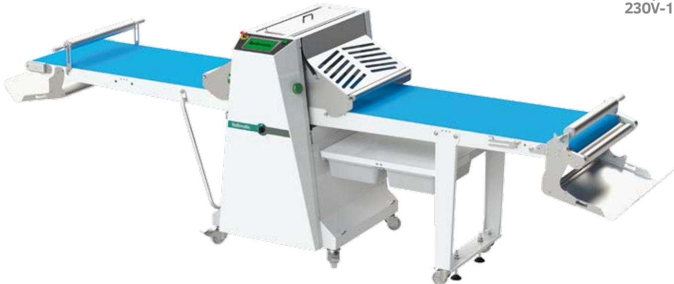
Sfogliatrice totalmente automatica su base con ruote, disponibile anche in versione con sistema di taglio incorporato(R65A-T). Tavoli ripiegabili ed estraibili. Touch screen da 7" con 100 programmi di lavoro. Protezioni dei cilindri con micro di sicurezza e molla a gas. Sistema rapido di tensionatura e sgancio dei tappeti. Raschiatori con rilascio rapido QR(Quick Release - brevetto Rollmatic). Cassetto farina con micro di sicurezza
