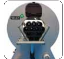
Rulli a "V" V-förmige Seitenführungsrollen Боковые прижимные валики V-образной формы
