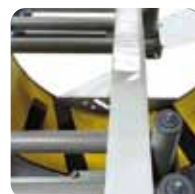
Doppia testata portabobina film Doppelte Folirollenaufnahme Одновременная работа с двумя рулонами пленки
