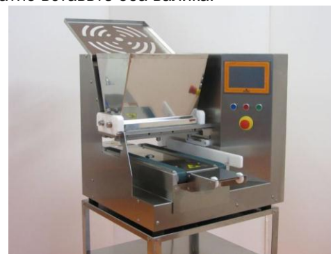
4. Вставьте бункер и закрепите его соответствующими гайками.
