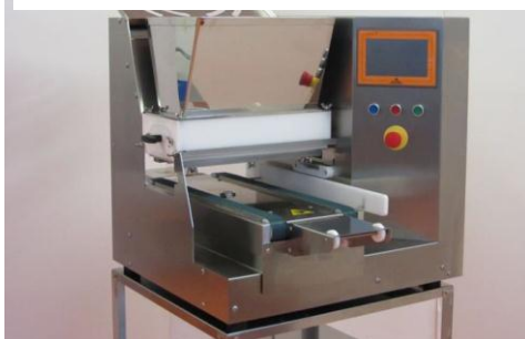
5. Осторожно подведите узел дозирования к несущей структуре, выровняв ведущий валик с соответствующей вставкой.
