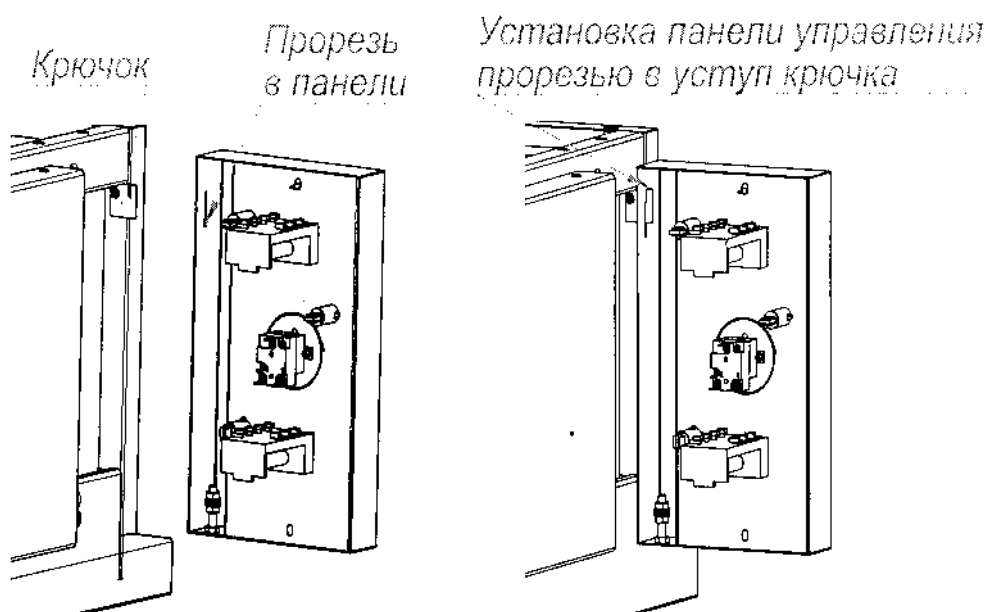
Рис.4 Схема установки панели управления при ТО
