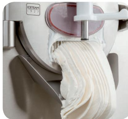
**Estrazione del gelato** - Al termine del ciclo, il gelato viene mantenuto in macchina alla giusta consistenza; l'estrazione è completa e rapida grazie all'alta velocità di rotazione delle pale e alla grande bocca di uscita.
